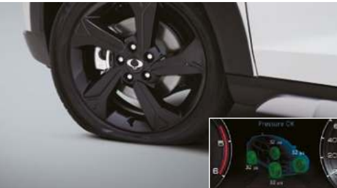
System kontroli ciśnienia w oponach (TPMS)
