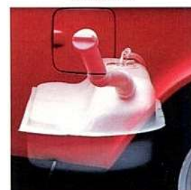
1974 - Depósito de combustível isolado e protegido
