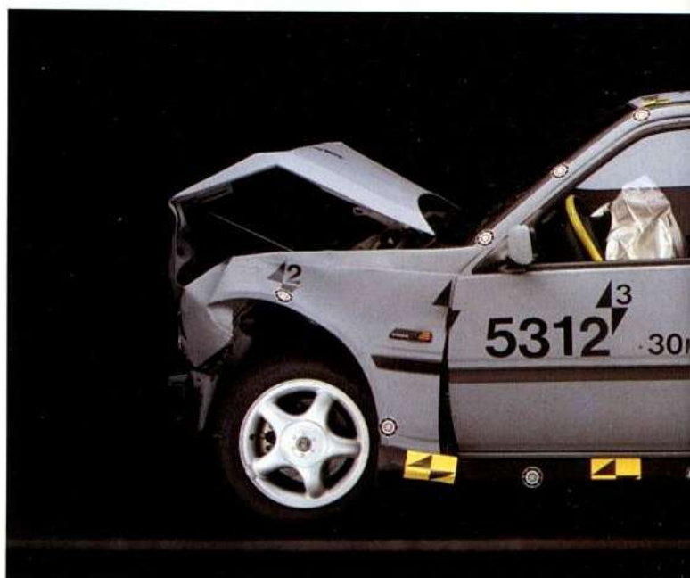
Uma grande parte da energia produzida pela colisão, é retida pela zonas de deformação, chegando uma pequena quantidade ao habitáculo.
