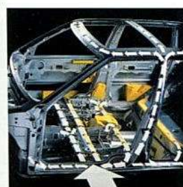
1991 - SIPS-Sistema de Protecção contra impactos laterais
