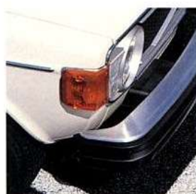
1973 - Pára-choques com características de absorção de energia
