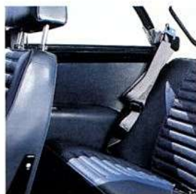
1967 - Cintos de dois pontos de fixação no banco traseiro
