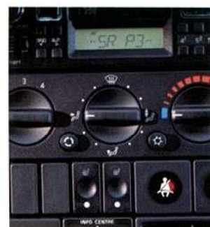
AC - AR CONDICIONADO MANUAL
