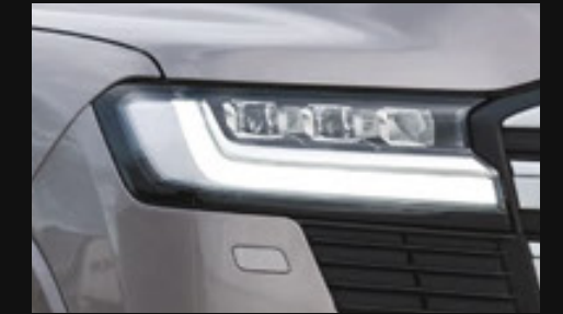
Faros delanteros full LED con regulación en altura y lavafaros.
