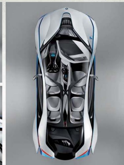
Концепт с посадочной формулой 2+2 уже в 2009 году отличался формой, похожей на каплю воды, – оптимальное решение с точки зрения аэродинамики.
