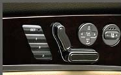
Память настроек положения сиденья водителя и боковых зеркал
