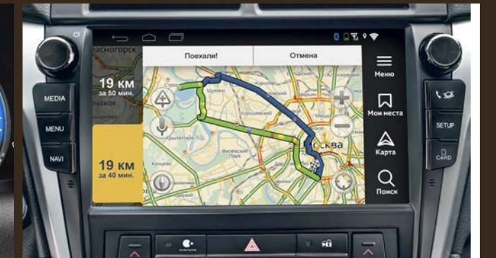
Мультимедийная система на платформе Android с цветным TFT-дисплеем 10 дюймов.
