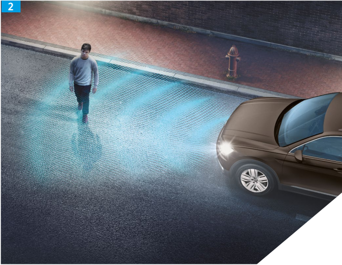
2 Следит за вами и за другими: система контроля дистанции спереди Front Assist со встроенной автоматической функцией торможения City Emergency Braking предупреждает водителя о препятствиях на полосе движения. При отсутствии реакции со стороны водителя система осуществляет автоматическое торможение. LE
