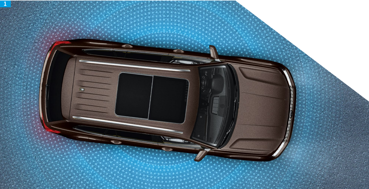
1 Всё под контролем: система кругового обзора Area View в новом Volkswagen Teramont выводит на дисплей до 12 возможных изображений пространства вокруг автомобиля в реальном времени, оказывая водителю помощь практически в любой дорожной ситуации. LE
