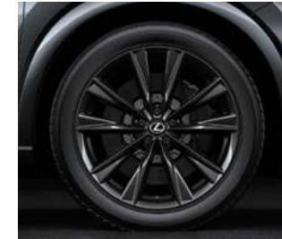
E_عجلات قياس 235/50R21101W وعجلة ألمنيوم 21x8J (Super Gross Black Metallic paint)
