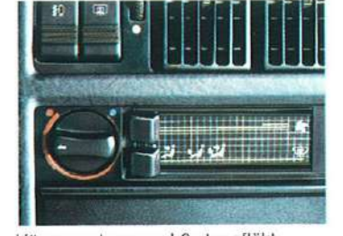
Värmesystem med 3-stegsfläkt.
