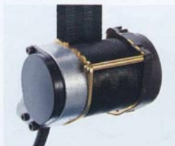
Säkerhetsbältsrulle med integrerad bältespännare, dvs tensionfunktionen.
