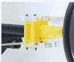
Fästet för sammandragningen av rattaxeln, dvs contractionfunktionen.
