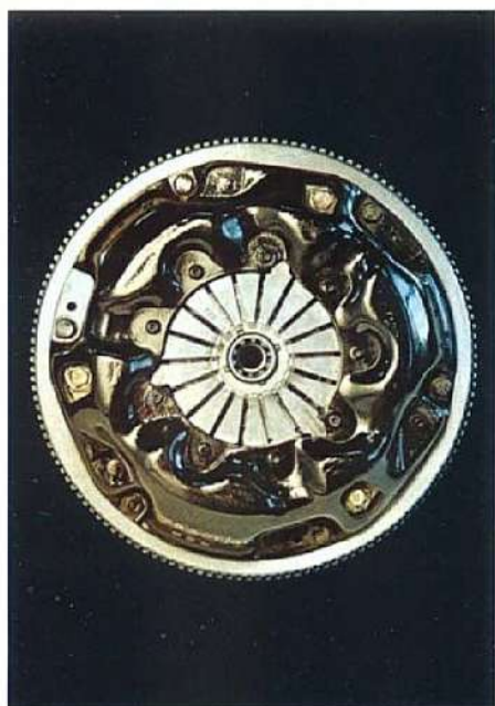
Solfjäderskoppling ger lågt pedaltryck
