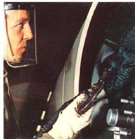
Fullständigt underredsbearbetad redan i fabriken
