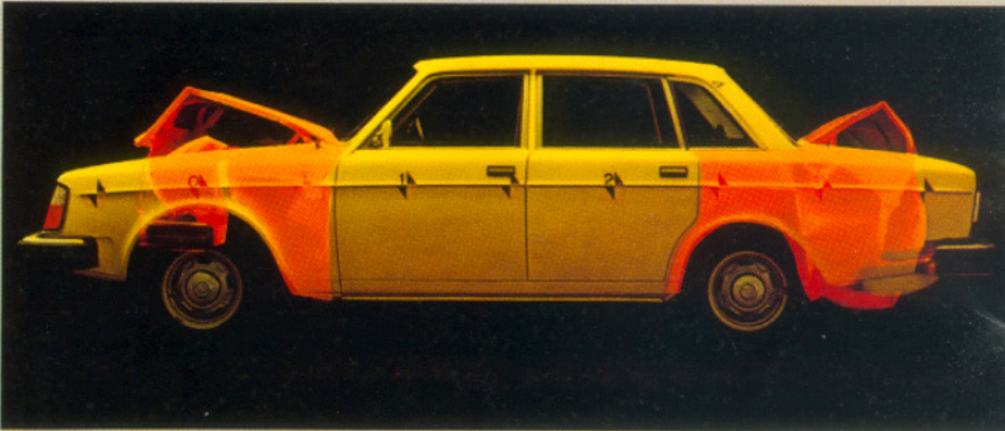
Der Volvo 242/244 hat Knautschzonen vorn und hinten und eine überrollsteife Fahrgastzelle.
