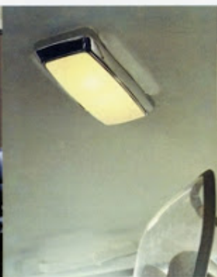
Den mittmonterade taklampan i Volvo Taxi har förstärkt effekt för att ge så god innerbelysning som möjligt.
