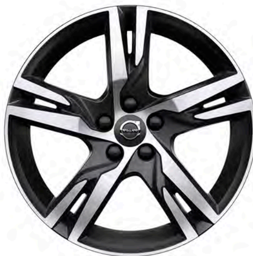
18-tum , 5-dubbelekrad design, Mattsvart Diamond Cut (Standard)
