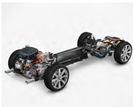
Batteriets placering ger en låg tyngdpunkt i din Volvo vilket bidrar till stabila, förutsägbara och komfortabla köregenskaper samtidigt som batteriet inte inkräktar på bilens lastutrymme.
