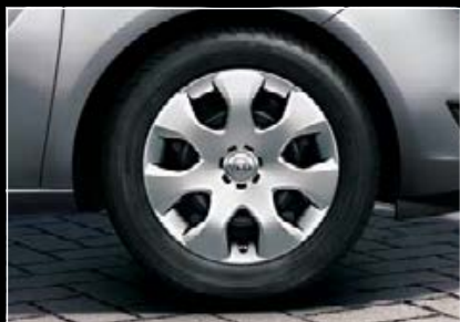
Jeklena platišča s pokrovi, 6,5J x 15", 7 krakov, pnevmatike 195/65 R 15 (PA7) 1 ali 6,5J x 16", pnevmatike 205/55 R 16 (PY3). 2
