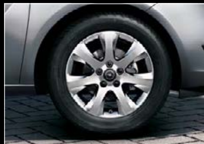
Platišča iz lahkih kovin, 6,5J x 16", 7 krakov, pnevmatike 205/55 R 16 (PWB). 4
