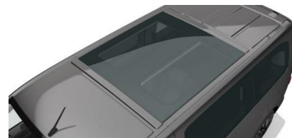
Presklená strecha so snečnou clonou (oK01)
