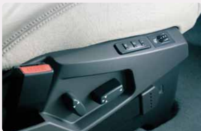
Sedadlo pre vodiča poskytuje ideálnu polohu pri riadení, keďže možno na ňom nastavovať výšku, vzdialenosť, sklon a zakrivenie v bedrovej oblasti*. Predné sedadlá môžu byť vybavené elektrickým nastavením s 2 pamätami a systémom vyhrievania**.
