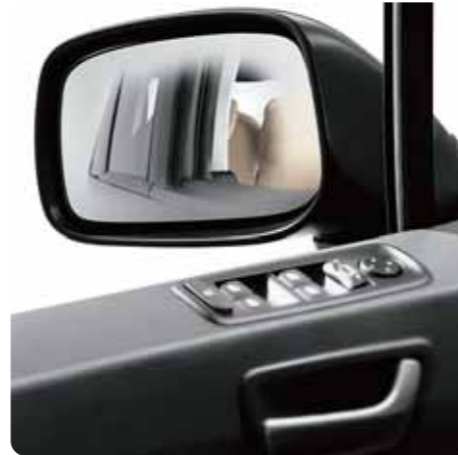
Vonkajšie spätne elektrické zrkadlá sú vyhrievané a elektricky sklápateľné*. Pomocou ovládania na dverách môže vodič zamknúť dvere a zadné okná.
