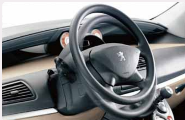
Aby bolo možné prispôsobiť polohu volantu pre každého vodiča, stĺpik riadenia je výškovo i osovo nastaviteľný.
