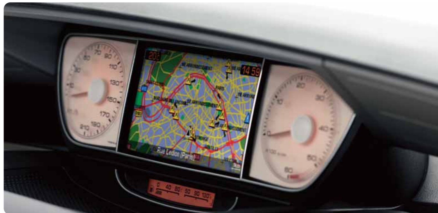
Na farebnej obrazovke systému RT3 so slonovinovým podkladom a oranžovým osvetlením sa zobrazujú informácie navigácie.
