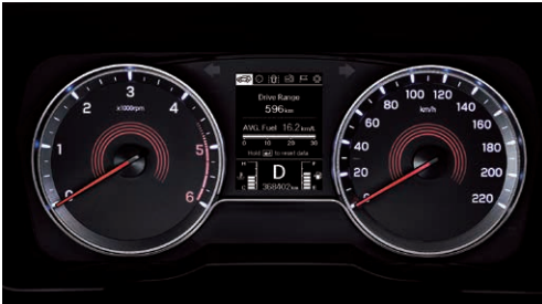
Palubný počítač vrátane monochromatického displeja 3.5"
