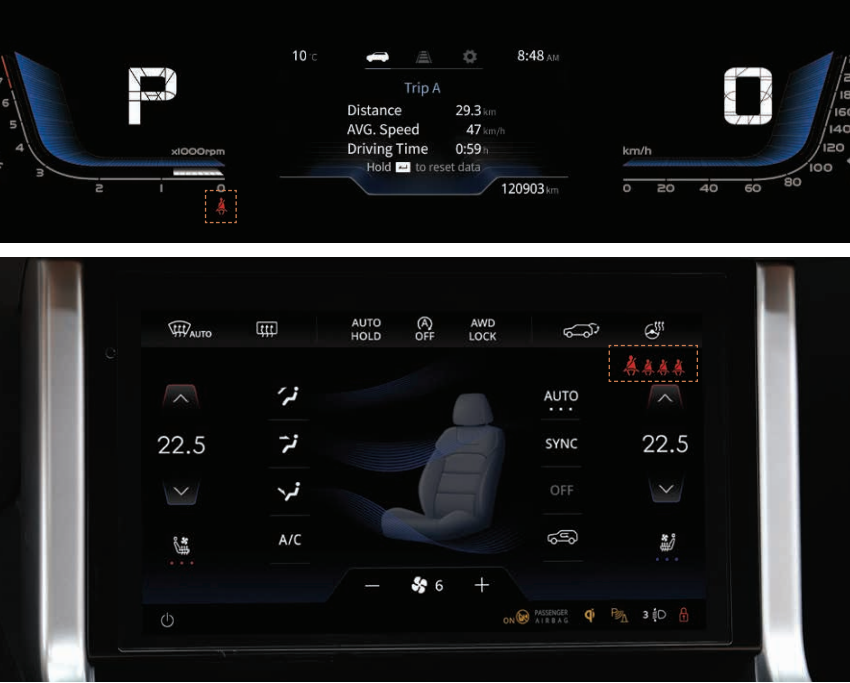
SIGNALIZÁCIA NEZAPNUTÝCH BEZPEČNOSTNÝCH PÁSOV (VŠETKÝCH 5 SEDADIEL)
