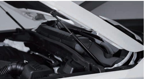
Podpery kapoty so vzduchovými tlmičmi
