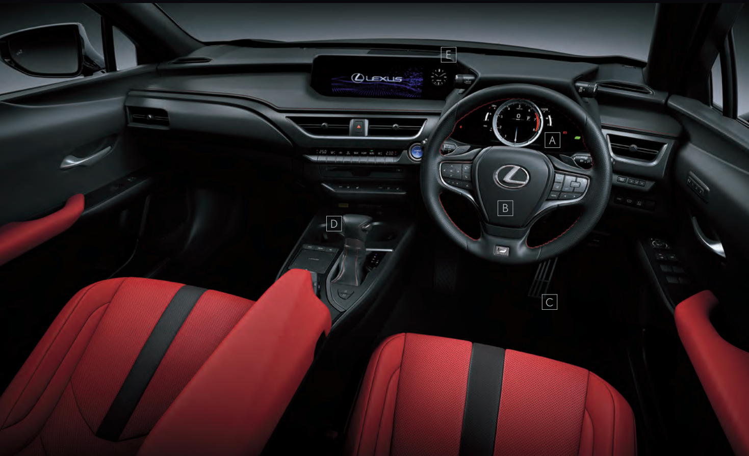
A_Meters & multi-information display / B_Steering wheel / C_Aluminum pedals / D_Shift lever knob / E_Clock A_มาตรวัดและจอแสดงข้อมูลรวม / B_พวงมาลัย / C_แป้นอลูมิเนียม / D_หัวคันเกียร์ / E_นาฬิกา
