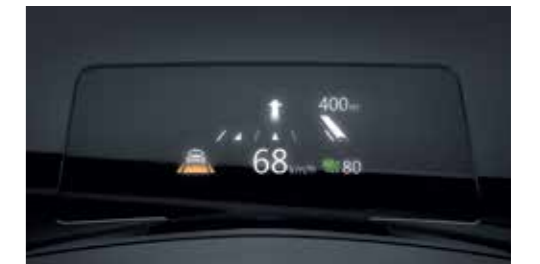
ACTIVE DRIVING DISPLAY สกรีนใส แสดงข้อมูลการขับขี่ที่สำคัญ ระดับความเร็ว และข้อมูลระบบนำทาง Navigator ชัดเจน อ่านง่ายในระดับสายตา โดยผู้ขับไม่ต้องละสายตาจากถนน ช่วยเพิ่มความปลอดภัยมากขึ้น
