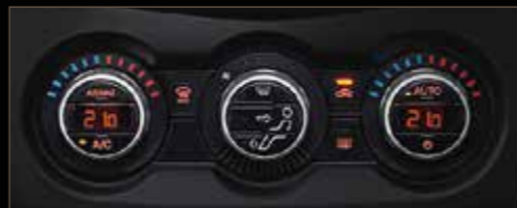
ระบบปรับอากาศอัตโนมัติ แยกอิสระซ้าย-ขวา
