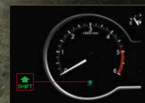
ฟังก์ชันเตือนเปลี่ยนเกียร์ Up-Shift Indicator
