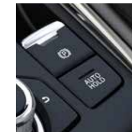
ELECTRONIC PARKING BRAKE ระบบเบรกมือไฟฟ้า พร้อมระบบ Auto Hold เพื่อ เพิ่มความสบายในการขับขี่
