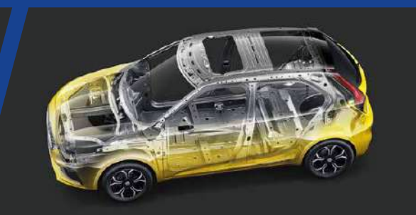
โครงสร้างตัวถังนิรภัย USD (ULTIMATE STIFFNESS DESIGN)
