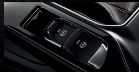
ระบบเบรกมือไฟฟ้า EPB และระบบป้องกันการไหลของรถโดยไม่ต้องเหยียบเบรกค้าง AVH
