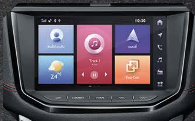
หน้าจอระบบสัมผัสขนาด 10 นิ้ว เชื่อมต่อโทรศัพท์ผ่านบลูทูธ พร้อมช่องต่อ USB 2 ช่อง
