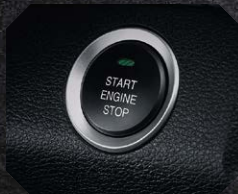
ปุ่ม PUSH START ทำงานร่วมกับระบบกุญแจนิรภัย IMMOBILIZER
