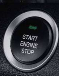
ปุ่ม PUSH START ทำงานร่วมกับ ระบบกุญแจนิรภัย IMMOBILIZER
