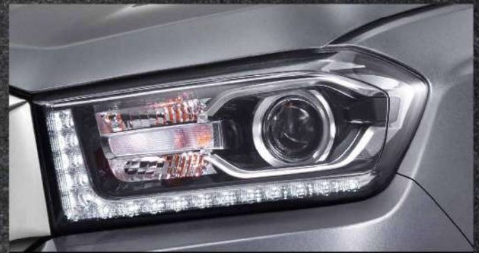
ไฟหน้าแบบ LED PROJECTOR มีระบบเปิด - ปิด และปรับเลี้ยวตามองศาพวงมาลัยอัตโนมิติ พร้อมไฟ DRL
