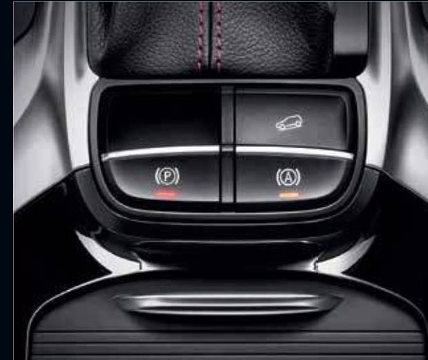
ระบบเบรกมือไฟฟ้า EPB และระบบป้องกันการไหลของรถ โดยไม่ต้องเหยียบเบรกค้าง AVH
