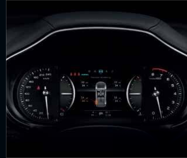
ระบบตรวจสอบความผิดปกติของลมยาง TPMS
