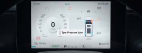
TPMS (TIRE PRESSURE MONITOR SYSTEM) ระบบวัดแรงดันลมยางอัตโนมัติ ช่วยตรวจสอบแรงดันลมยางของแต่ละล้อได้ หากพบความผิดปกติจะแจ้งเตือนที่หน้าจอทันที
