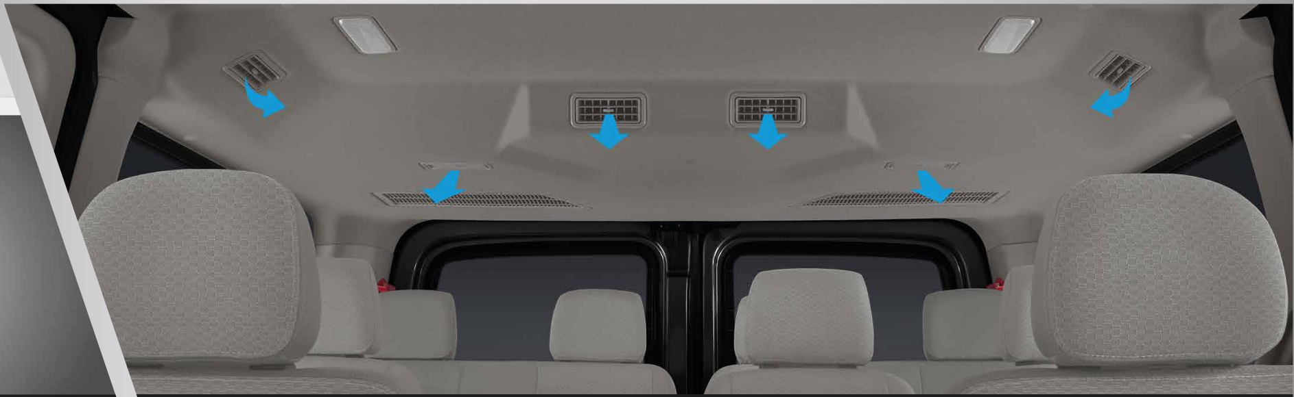
ระบบปรับอากาศ แยกอิสระหน้า / หลัง
