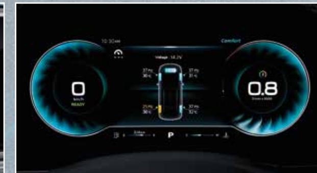
ระบบ TPMS สำหรับตรวจสอบความผิดปกติของลมยาง
