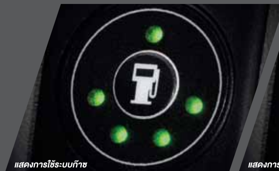
แสดงการใช้ระบบก๊าซ
