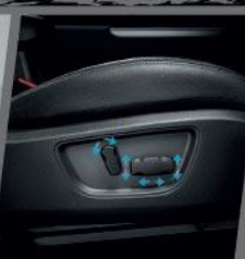
สวิตช์ควบคุมด้วยเบรคไฟฟ้า ปรับระดับ 8 ทิศทาง (เฉพาะรุ่น Double Cab Plus)
