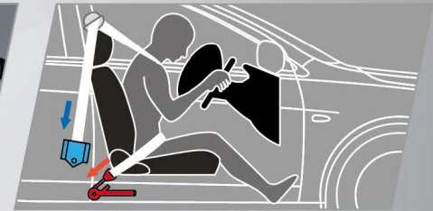
2-WAY PRETENSIONER WITH FORCE LIMITER FRONT SEATBELTS (DRIVER SIDE) เข็มขัดนิรภัยด้านคนขับแบบดึงกลับ และฟ่อนแรงอัตโนมัติ แบบ 2 ทิศทาง
