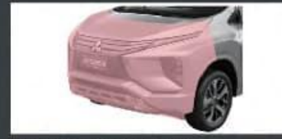
PEDESTRIAN PROTECTION ด้วยเอกลักษณ์การออกแบบตั้งกำแพงด้านหน้า ช่วยลดความรุนแรงจากแรงกระแทกของรถที่เกิดขึ้นกับคนเดินถนนให้น้อยลง หากเกิดอุบัติเหตุ
