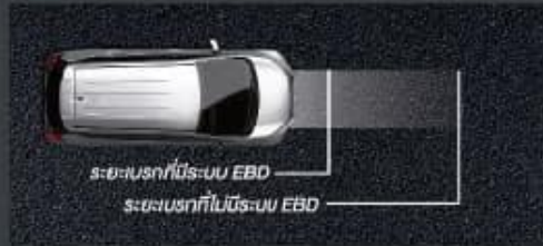
ELECTRONIC BRAKE FORCE DISTRIBUTION (EBD) ระบบกระจายแรงดันน้ำมันเบรกแบบอิเล็กทรอนิกส์ ทำงานประสานกับระบบเบรก ABS เพื่อให้เกิดการกระจายแรงเบรกอย่างเหมาะสมทั้ง 4 ล้อ ช่วยลดระยะเบรกให้สั้นลง
