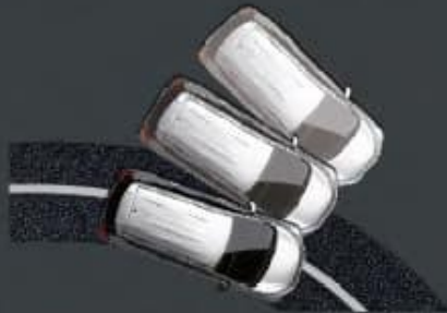
ACTIVE STABILITY CONTROL (ASC) ระบบควบคุมเสถียรภาพการทรงตัว ในสภาวะที่รถเสียสมดุล เพื่อช่วยควบคุมรถที่ที่เกิดการสั่นไถลออกนอกเส้นทาง เช่น กรณีหลุดโค้งเมื่อเข้าโค้งด้วยความเร็วสูง ถนนลื่น หรือตีหล่นกะทันหัน
