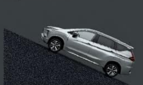
HILL START ASSIST (HSA) ระบบช่วยออกตัวบนทางลาดชัน ช่วยป้องกันรถไหลเมื่อต้องออกตัวบนทางลาดชัน
