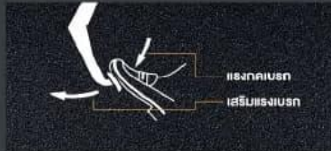
BRAKE ASSIST (BA) ระบบเสริมแรงเบรก จะทำงานทันทีที่เหยียบเบรกจะกันคนระบบนี้จะช่วยเพิ่มแรงดันน้ำมันเบรกให้มากขึ้น เพื่อช่วยป้องกันการหยุดรถเป็นไปอย่างรวดเร็ว
