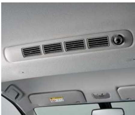
REAR CLIMATE CONTROLS WITH VENTILATION OUTLET ระบบปรับอากาศด้านหลังแบบแยกอิสระ พร้อมแผงควบคุม และช่องแอร์สำหรับผู้โดยสารตอนหลัง
