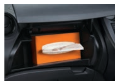
กล่องเก็บของตอนหน้า พื้นที่เก็บของกว้าง เปิดสะดวกด้วยฝาปิดด้านบน
