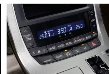
ระบบปรับอากาศแบบแยก ปรับอุณหภูมิ ซ้าย-ขวา บริเวณที่นั่งผู้โดยสาร ด้านหน้า พร้อมระบบปรับอากาศแบบแยกปรับ อุณหภูมิ หน้า-หลัง บริเวณที่นั่งผู้โดยสารด้านหลัง
