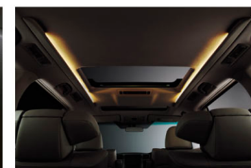
ไฟส่องสว่างในห้องโดยสารแบบซ่อนผ้า สามารถปรับความสว่างได้ 4 ระดับ
