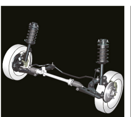
ช่วงล่างหน้าแบบแม็คเฟอร์รอนส์ พร้อมเหล็กกันโคลง หนุนมวลเหนือขึ้นในทุกสภาพถนน
