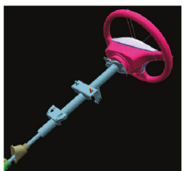
พวงมาลัยยวบยวดัดเมื่อเกิดอุบัติเหตุ เพิ่มความปลอดภัย ป้องกันผู้ขับขี่จากแรงกระแทก
