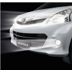
ไฟหน้าแบบ Multi Reflector และไฟตัดหมอกหน้าสว่างชัดเจน เพิ่มทัศนวิสัยในการขับขี่
