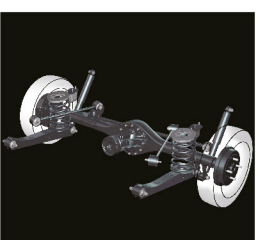
ช่วงล่างหลังแบบโฟร์ลิงค์คอสส์สบริง พร้อมคานควบคุมการบิดตัวแนวขวาง ชื่นชอบนิลสกีกราฟิก เกาะถนนและทนทานทุกสภาวะ
