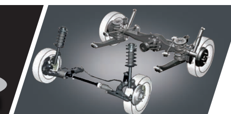
ช่วงล่างแบบเมคเฟอร์สันสตรีก พร้อมเหล็กกันโคลง และช่วงล่างหลังแบบโฟว์ลิงค์ค้อยล์สปริง พร้อมควบคุมการบิดตัวแนวขวาง นุ่มนวลทุกสภาพถนน ทรงตัวนิ่ง
