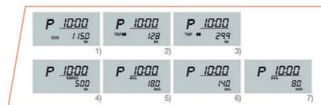
จอแสดงข้อมูลการขับขี่ MID (Multi Information) แสดงข้อมูลในการขับขี่ 1. ระยะทางรวม 2. Trip A 3. Trip B 4. ระยะที่ใช้จากบ้านถึงที่จอดอยู่ 5. อัตราการใช้น้ำมันเฉลี่ย 6. อัตราการใช้น้ำมันในขณะนั้น 7. ความเร็วเฉลี่ย
