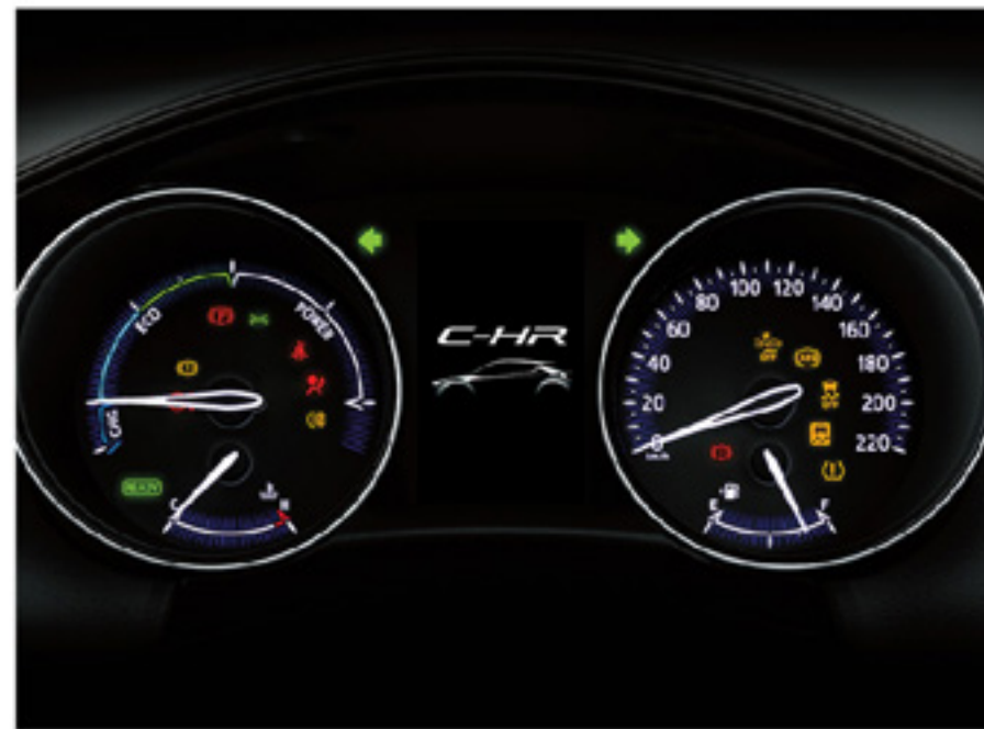
มาตรวัดแบบ Optitron พร้อมหน้าจอแสดงข้อมูลการขับขี่แบบ TFT ขนาด 4.2 นิ้ว
