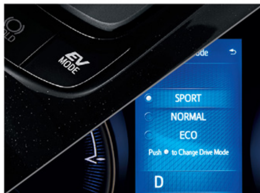
EV MODE ระบบจะใช้กำลังจากมอเตอร์ไฟฟ้าสำหรับเดินทาง ในความเร็วต่ำอย่างเงียบสนิท SPORT MODE ระบบจะเพิ่มสมรรถนะในการขับขี่และตอบสนอง อัตราเร่งได้ดียิ่งขึ้น ECO MODE ระบบจะช่วยลดการใช้พลังงานที่สิ้นเปลือง โดยปรับ การทำงานของเครื่องยนต์และเครื่องปรับอากาศให้มีการใช้พลังงาน อย่างมีประสิทธิภาพ
