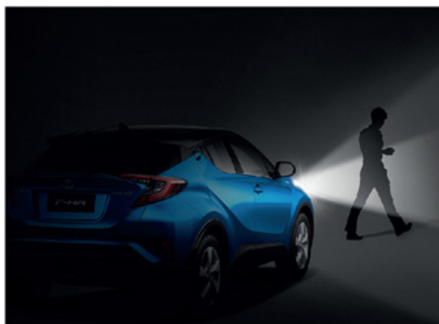
ระบบปรับระดับไฟหน้าสูง-ต่ำอัตโนมัติและระบบควบคุมการเปิด-ปิดไฟหน้าอัตโนมัติ พร้อมระบบ Follow-Me-Home
