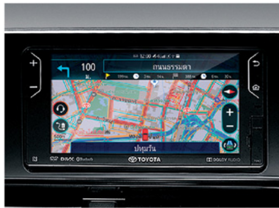
หน้าจอระบบสัมผัส ขนาด 7 นิ้ว และเครื่องเล่น DVD/ CD/ MP3/ WMA พร้อมช่องเชื่อมต่อ USB/ HDMI/ MICRO SD CARD พร้อมระบบนำทาง รองรับเทคโนโลยี TELEMATICS
