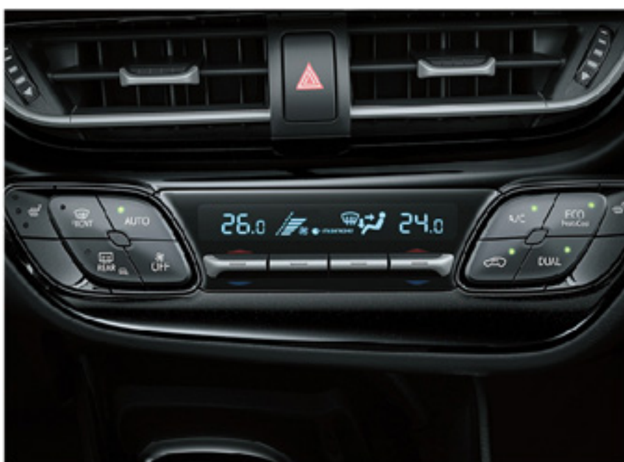
ระบบแยกปรับอากาศ Dual Zone ปรับอุณหภูมิบริเวณที่นั่งผู้โดยสาร ด้าน ซ้าย-ขวา อย่างอิสระ
