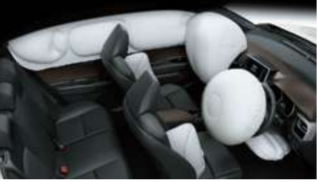
ถุงลมนิรภัย 7 ตำแหน่ง ปกป้องผู้ขับขี่และผู้โดยสาร ด้วยถุงลมนิรภัยคู่หน้า ด้านข้าง ด้านหน้าข้าง และหัวไหล่ด้านคนขับ
