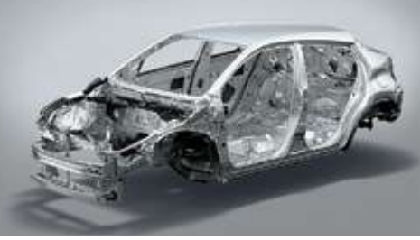
โครงสร้างตัวถังนิรภัย GOA พร้อมคานนิรภัย ช่วยดูดซับแรงกระแทกได้อย่างดีเยี่ยม รวมทั้งคานนิรภัยที่ประตูทั้ง 4 บาน
