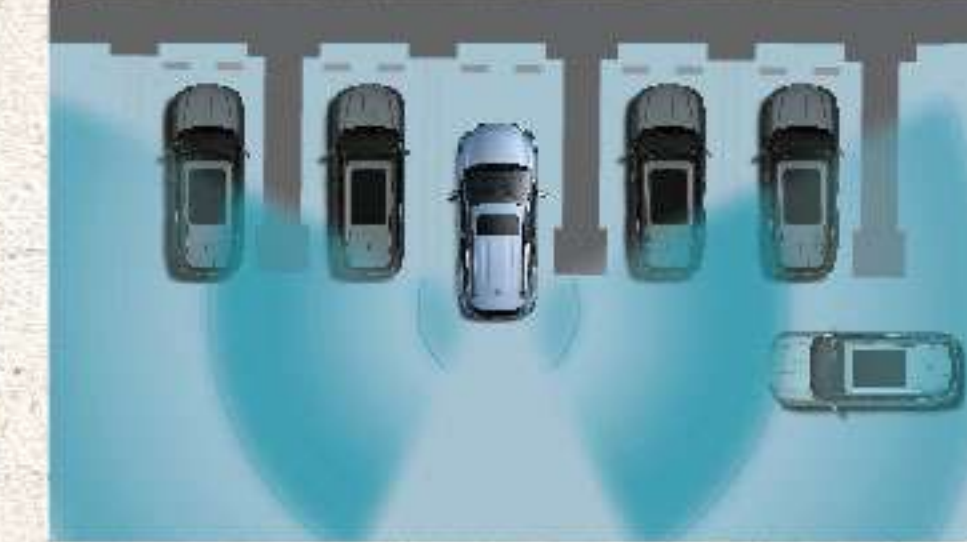
Rear Cross Traffic Alert ระบบช่วยเตือนขณะถอยรถ
