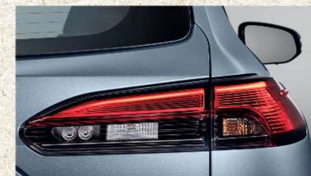
ไฟท้าย LED แบบ Light Guiding
