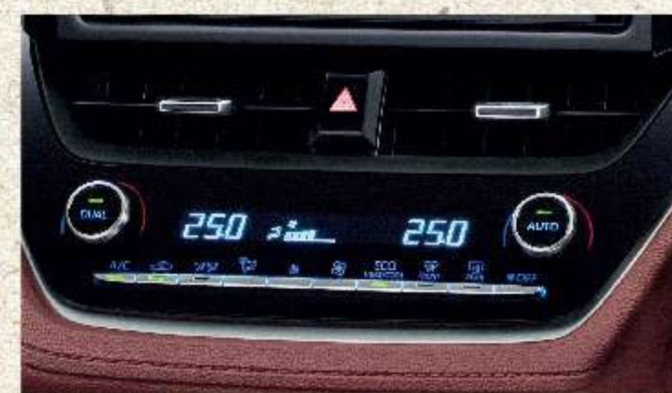
ระบบปรับอากาศอัตโนมัติ Dual Zone ปรับอุณหภูมิตามซ้าย-ขวาอย่างอิสระ
