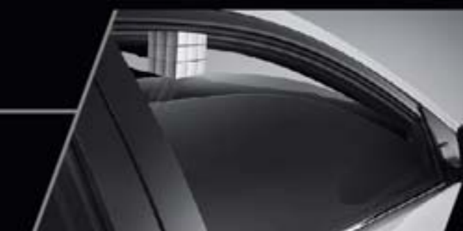
กระจกไฟฟ้าพร้อมระบบ Jam-Protection ด้านคนขับ เลื่อนลงอัตโนมัติเมื่อมีสิ่งกีดขวาง
