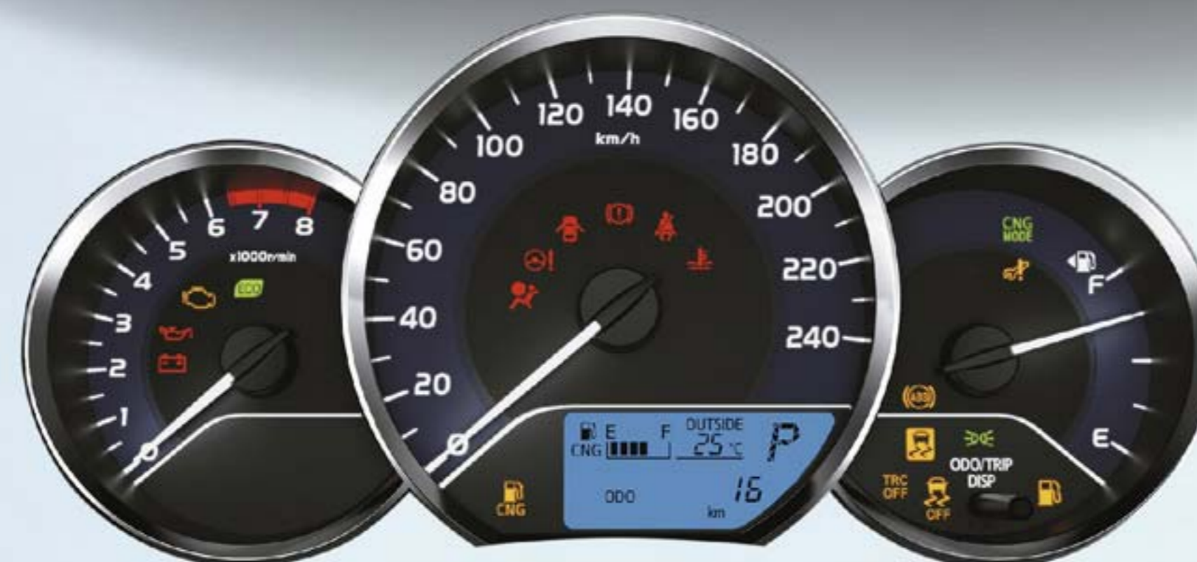
ไฟแสดงสถานะการใช้ก๊าซ (CNG MODE) พร้อมบอกระดับก๊าซที่เหลืออยู่
