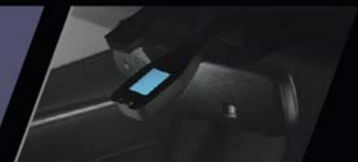
ระบบควบคุมการปิดน้ำฝนอัตโนมัติ (Rain Sensor) ทำงานอัตโนมัติทันที ที่เซ็นเซอร์ตรวจจับ น้ำฝนได้ พร้อมปรับระดับความเร็วในการปิด ให้สัมพันธ์กับปริมาณน้ำฝนในขณะนั้น
