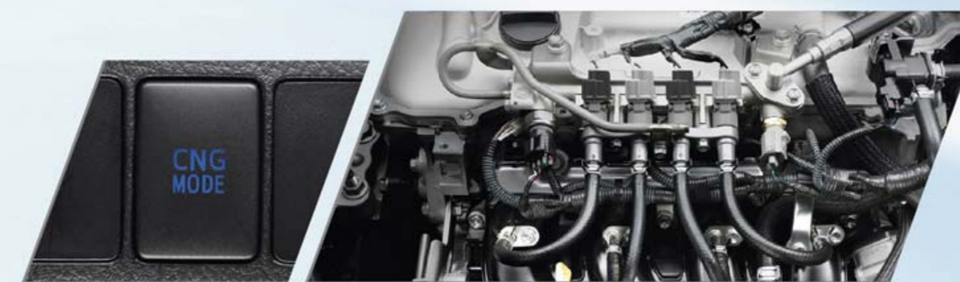
สวิตช์เลือกชนิดเชื้อเพลิง สามารถใช้ได้ทั้งระบบน้ำมัน และก๊าซ E85 และก๊าซ CNG
