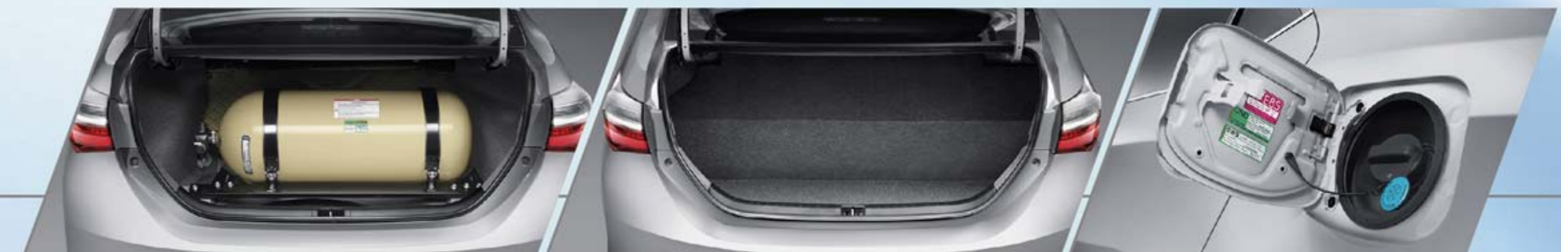
ถังบรรจุก๊าซ CNG ความจุ 75 ลิตร พร้อมลิ้นเปิด-ปิดอัตโนมัติ ถังทำจากเหล็กชนิดพิเศษ (Chromium Molybdenum Steel) น้ำหนักเบา ทนทานสูง ซึ่งมีฐานรองรับ และตัวยึดถังก๊าซ พร้อมลิ้นเปิด-ปิดอัตโนมัติ ช่วยควบคุมการจ่ายก๊าซแรงดันสูงตามคำสั่ง ของกล่องอิเล็กทรอนิกส์ ซึ่งปรับค่าให้เหมาะสมกับความต้องการของเครื่องยนต์ แผงกั้นถังก๊าซ เพิ่มความสะกดก สบายงามและป้องกันการกระแทกบริเวณที่เก็บสัมภาระท้ายรถ
