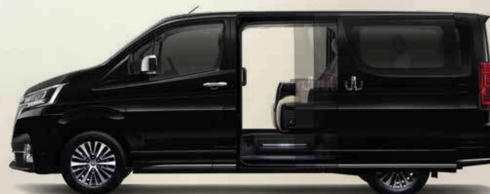
ประตูบานสไลด์อัตโนมัติ 2 ด้าน พร้อมระบบป้องกันการหนีบ
