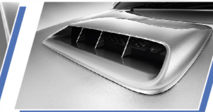
ช่องดักลมขนาดใหญ่ ที่ตำแหน่งกลางฝากระโปรง ช่วยระบายความร้อนของอากาศ ที่เข้าสู่ห้องเผาไหม้ ทำให้เผาไหม้หมดจด แรงจัดและประหยัดยิ่งขึ้น
