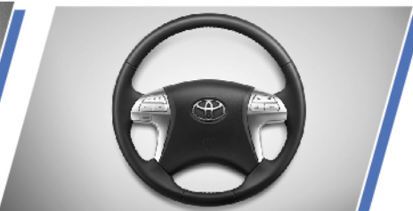
พวงมาลัย 4 ก้าน แบบปรับระดับสูง-ต่ำได้ พร้อมปุ่มควบคุมเครื่องเสียง การโทรออก ด้วยเสียง รับ-วางสายโทรศัพท์ และ MID
