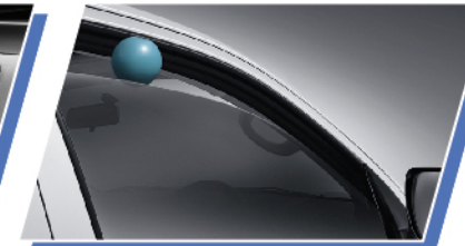
กระจกไฟฟ้าขึ้น-ลงแบบอัตโนมัติ พร้อมระบบป้องกันการหนีบ (Jam Protection) เฉพาะด้านผู้ขับขี่
