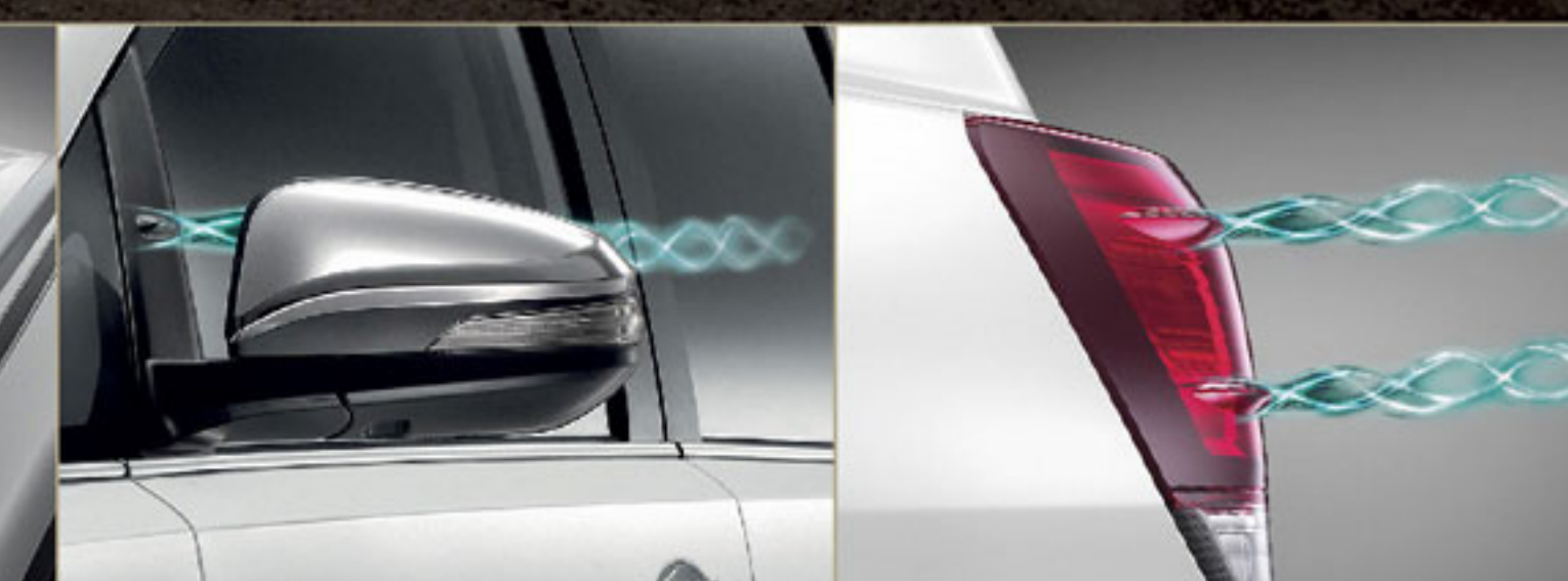
แอโรไดนามิก ฟิน (Aerodynamic Fin) ออกแบบตามหลักอากาศพลศาสตร์ ช่วยลดแรงปะทะของลม พร้อมทั้ง Fin บริเวณกระจกมองข้างและไฟท้าย ส่งพลให้การทรงตัวรถดีเยี่ยม
