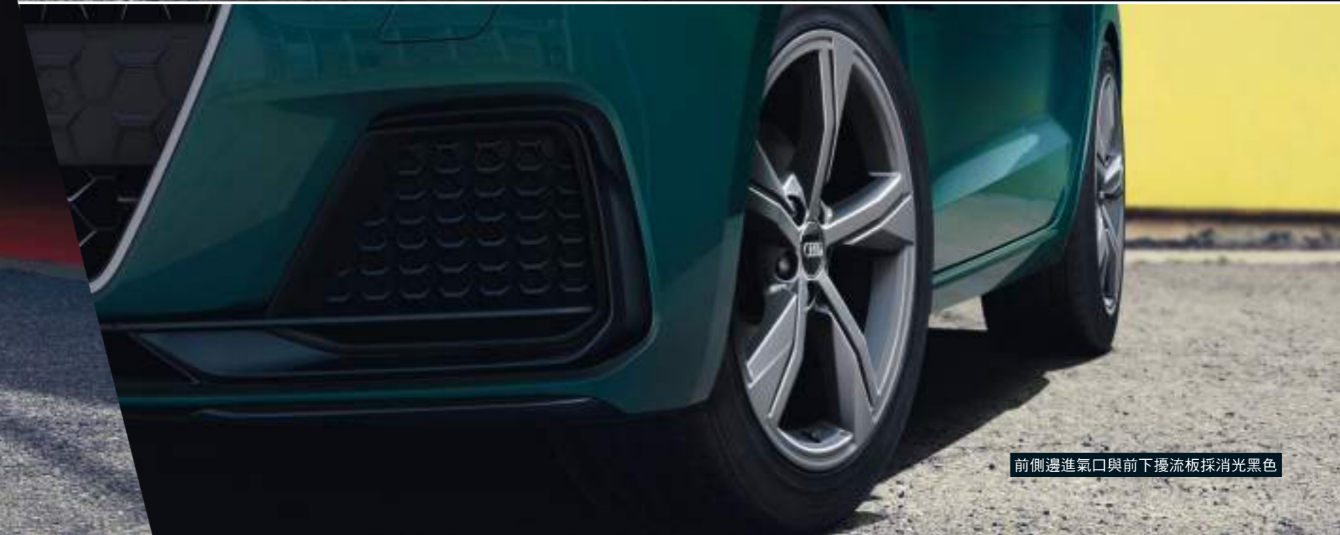
10 幅渦輪式設計鑄造鋁合金輪圈， 尺寸 6.5 J x 16 搭配 195/55 R 16 輪胎
